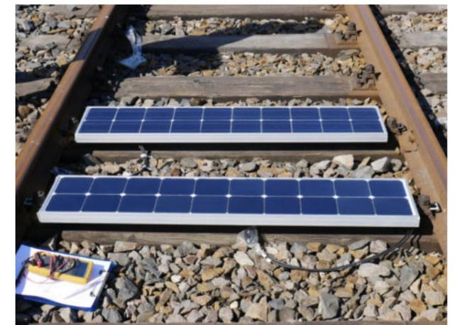
Solarmodule auf Bahnschwellen © Bankset Energy
